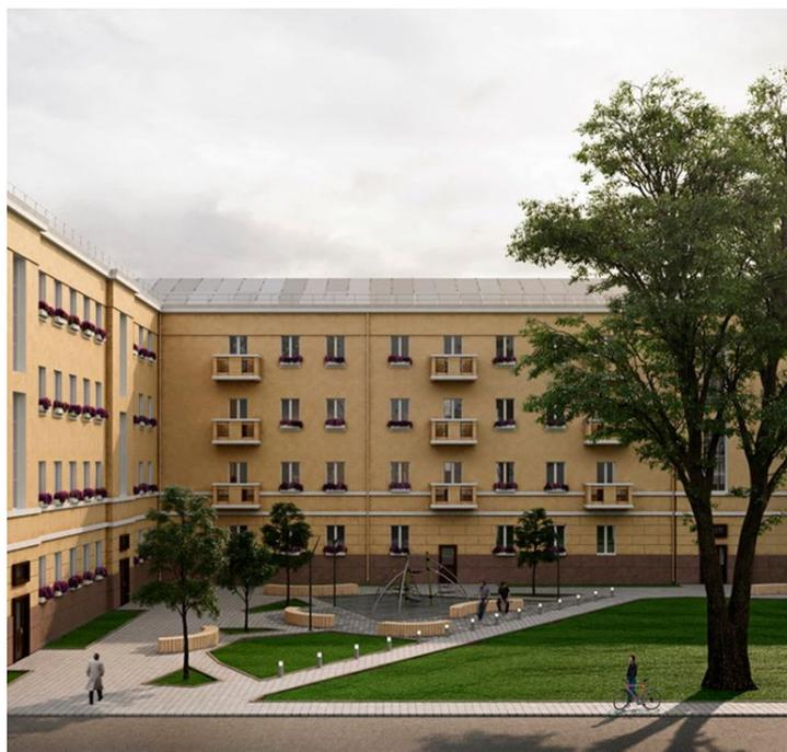
В проекте «Крона» в ходе капитального ремонта несущие конструкции полностью заменены на монолитно железобетонные, а так же выполнено усиление фундамента. В отделке наружных стен применяется штукатурка желтого оттенка. Все инженерные системы водоснабжения, вентиляции, энергоснабжения и отопления заменены, вместе со счетчиками электроэнергии и воды.
